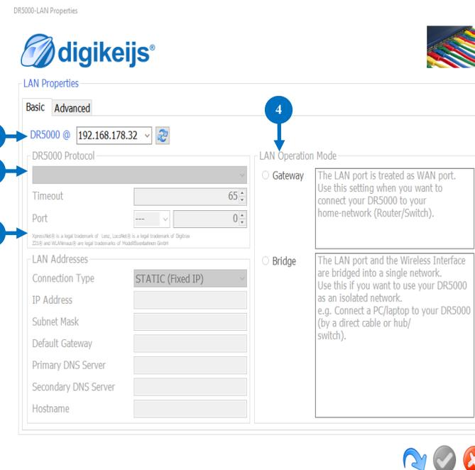
Se la DR5000 **non** è collegata tramite interfaccia LAN alla **rete domestica** (router) o tramite **WLAN** sul PC o al laptop, le impostazioni LAN del DR5000 **sono disattivate e non accessibili** e quindi **non possono** essere modificate! Una connessione tramite **USB** al DR5000 è **sempre richiesta per cambiare** l'impostazione LAN!
