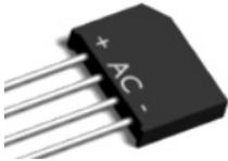
Modellbahntransformatoren liefern in der Regel am Lichtausgang eine Wechselspannung. Eine Wechselspannung würde die Schaltung zerstören. Daher kommt ein Brückengleichrichter, der die Wechselspannung gleichrichtet, zum Einsatz. Das Bauteil hat zwei Wechselspannungseingänge, (gekennzeichnet mit „~ / AC“) und zwei Ausgänge für die Gleichspannung, (gekennzeichnet mit „+,-“).
