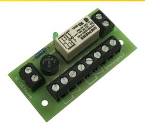
Der Baustein ist für das Ein-, Aus- oder Umschalten von Blockstellen, Steuerleitungen, Gleisabschnitten oder elektrisch betriebenen Modellbahn-Zubehör (z.B. Signale, Weichen, Schranken, Beleuchtung usw.) aller Systeme geeignet.
